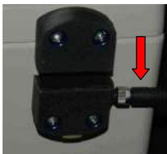
Sicherungs-Sensoren mit Kabel zur Timer-Steckdose IB-TSD-3 Kontrollleuchte hellgrün, Strom ein
