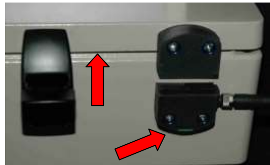
Inert-Box leicht geöffnet mit Sicherungs-Sensoren Kontrollleuchte: dunkelgrün, Strom aus
